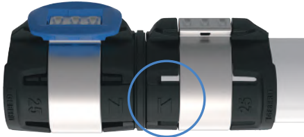
Afbeelding 4: Bij een correcte insteekdiepte is de buis door beide inspectievensters te zien.
